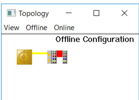
Der Embedded-PC CX5020 (-A1) wird innerhalb von TwinCAT 3 lediglich durch die intern verbaute Schnittstellenkarte EK1200-5000 dargestellt.
