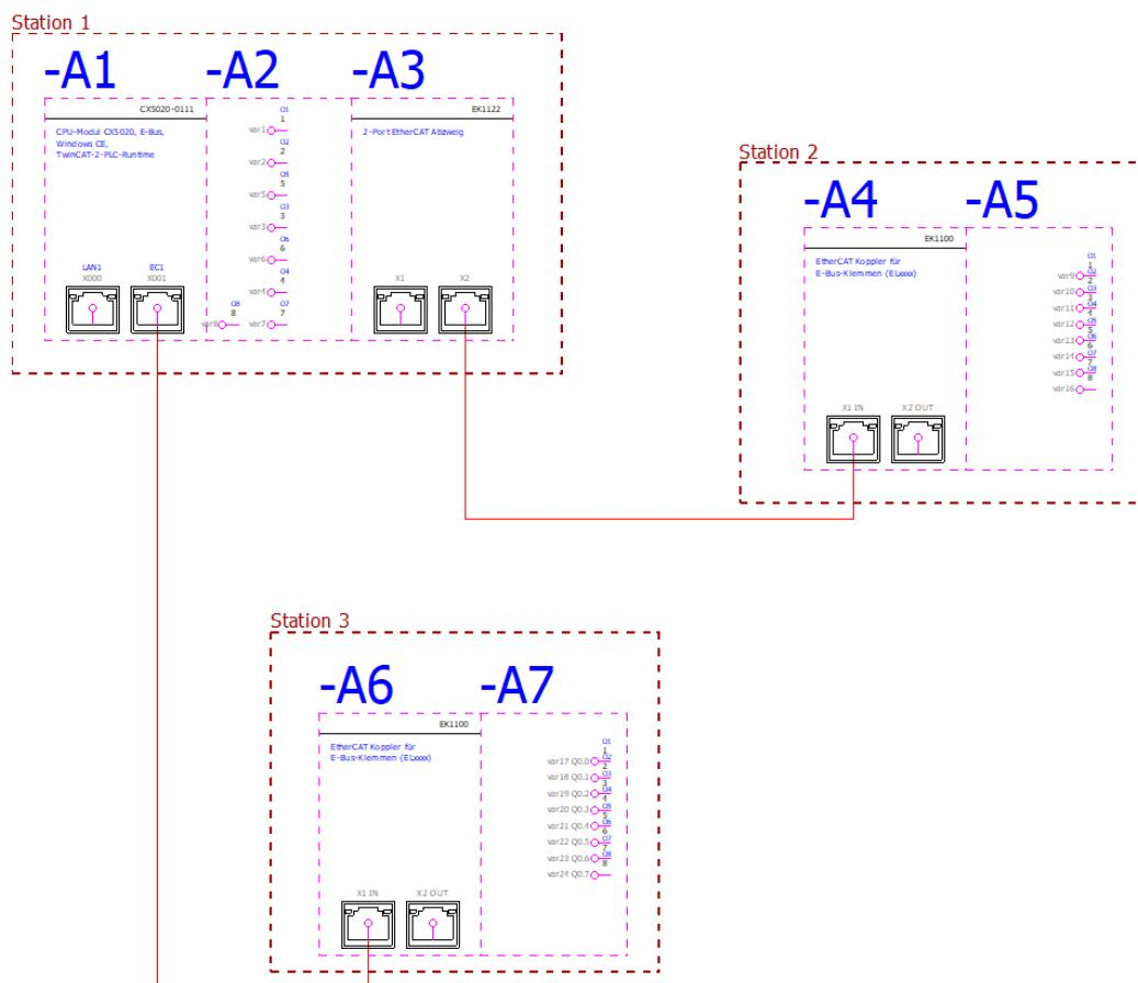
Existieren in einem Projekt mehrere EtherCAT-Netzwerke, dann ist es erforderlich, dass alle Netzwerke zusätzlich als logische Netze definiert werden.
